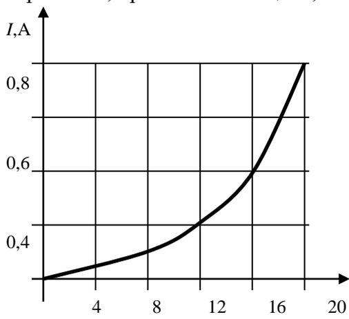
Задание 2. Определить ток и напряжение на нелинейном резисторе  $R_2$ , вольтамперная характеристика которого задана на рисунке.
